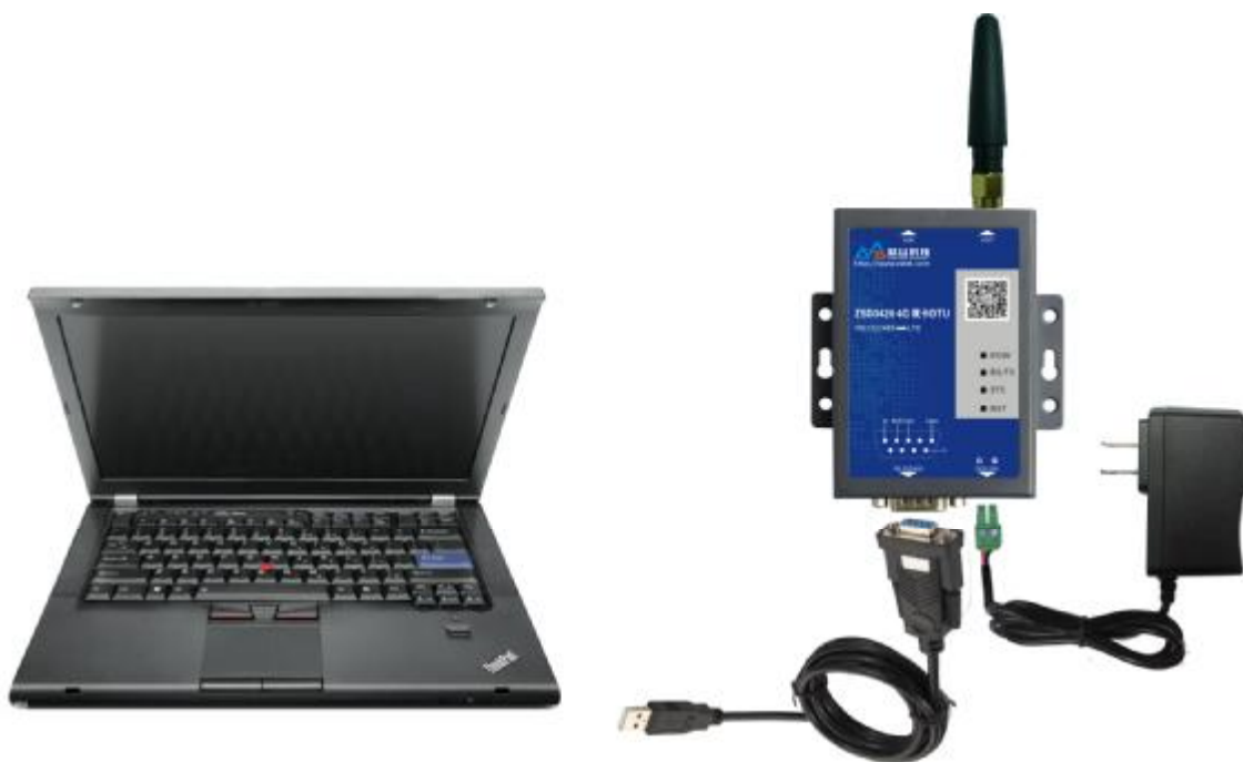
DTU 测试连接示意图
