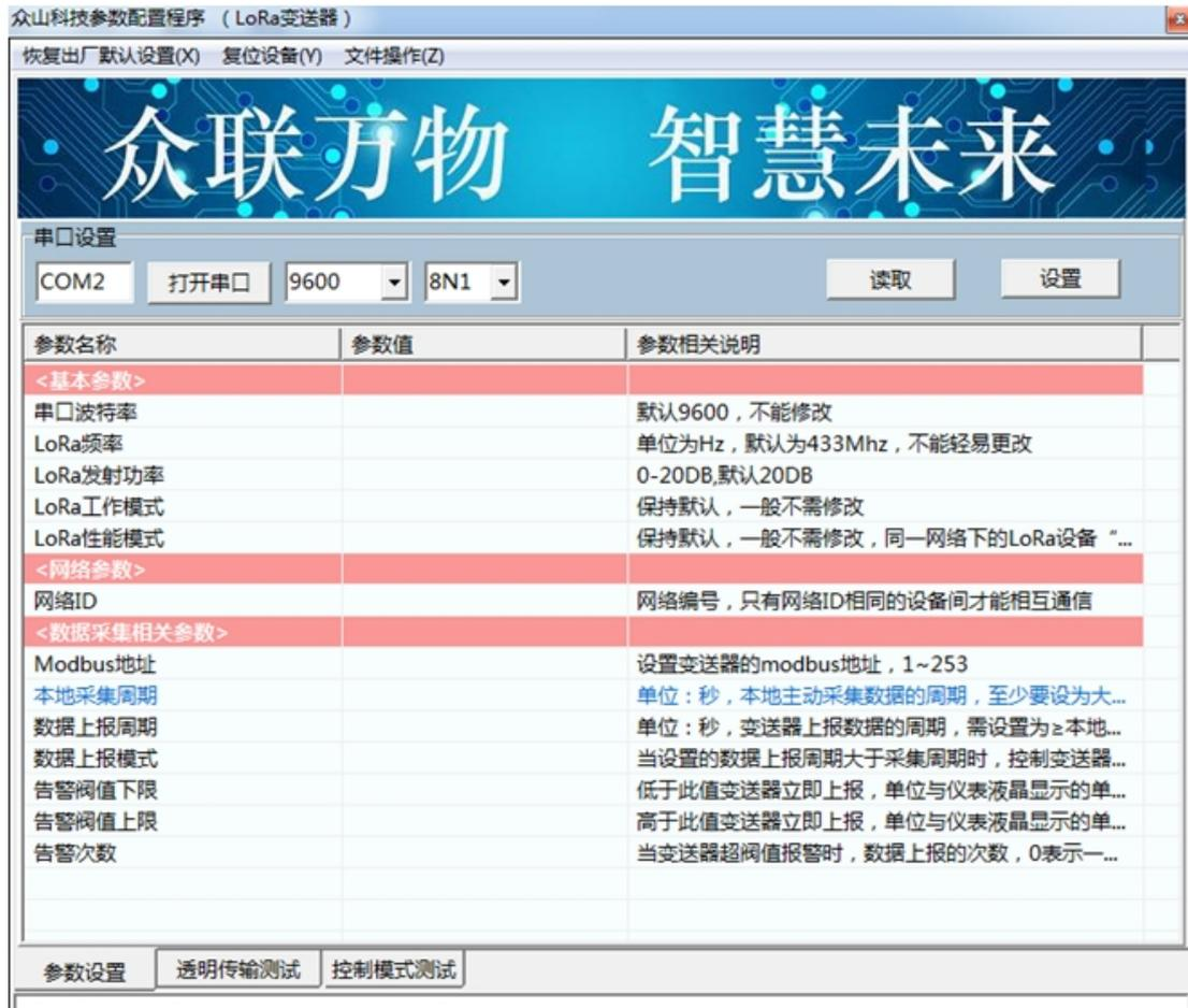
在“参数设置”页中，点击右上角的“读取”按钮，参数值一栏会显示出当前 lora 变送器内部所有参数值。
