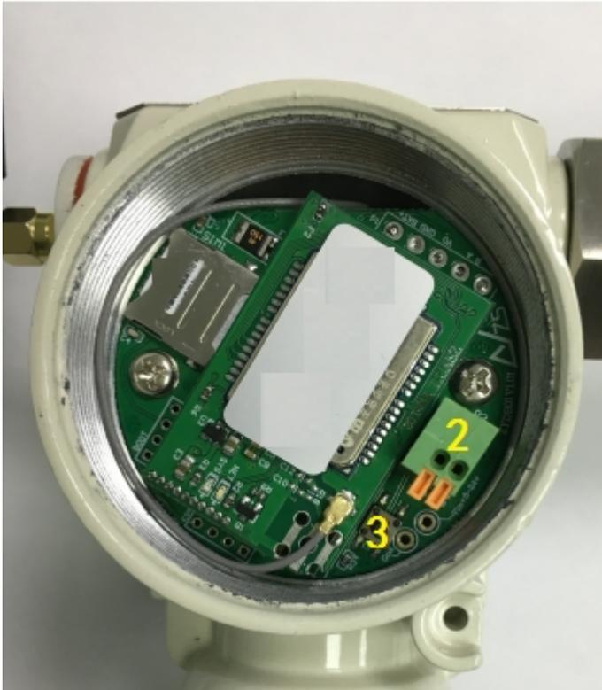
2 号位置为 RS485 接口, 通过此接口可以配置设备的参数, 主板上标注了接口的线序
